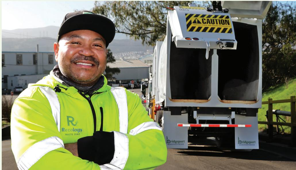
El conductor de Recology Sunset Scavenger, Ivan Balzar, muestra cómo una pared metálica en la carrocería de su camión de recolección mantiene los materiales compostables separados de la basura.
